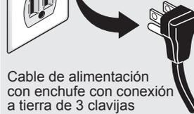
Cable de alimentación con enchufe con conexión a tierra de 3 clavijas
