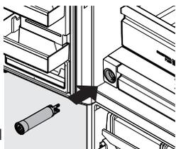
al cajón de temperatura regulable. En general, debe cambiar el filtro de agua cada 6 meses para garantizar la mayor calidad posible del agua. **El estado del filtro de agua** en la interfaz de usuario le solicita que cambie el filtro después de que una cantidad estándar de agua (125 gal/453 l para **PurePour™**) haya fluído a través del sistema.
