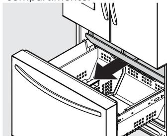
3. Empuje ligeramente hacia adentro las lengüetas de la canasta para liberar la canasta superior de los montajes de la corredera (1 por lado, en el frente).
