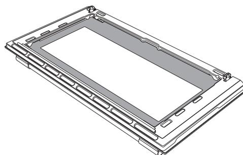
4. Vuelva a colocar los vidrios siguiendo la secuencia del desmontaje en forma inversa. Vuelva a posicionar el vidrio interior. Centre e inserte cuidadosamente los 4 pernos en sus ranuras en la puerta del horno ejerciendo una leve presión.
