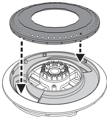
3. La tapa del quemador debe estar nivelada y centrada con respecto al zócalo del quemador.
