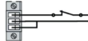
**Contacto abierto:** Desconexión de la UPS .
