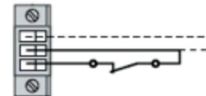
**Contacto abierto:** La UPS se desconecta y se enciende el LED (3) de falla.
