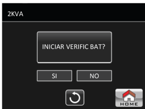
Autoverificación de batería
